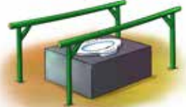
ແຜ່ນປົກເຮັດດ້ວຍແຜ່ນຊີນັງ ແລະ ມີຫົວອິດຍົກສູງຈາກພື້ນ. ສອງຂ້າງມີຮາວໄມ້ ຫຼື ເຫຼັກສຳລັບຈັບ.
