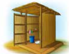
ຝາ: ໃຊ້ໄມ້ທ່ອນນ້ອຍລຽນລຳແອ້ມ ຫຼັງຄາ: ໃຊ້ເຟືອງ ຫຼື ໄມ້ຟາກມຸງ.
