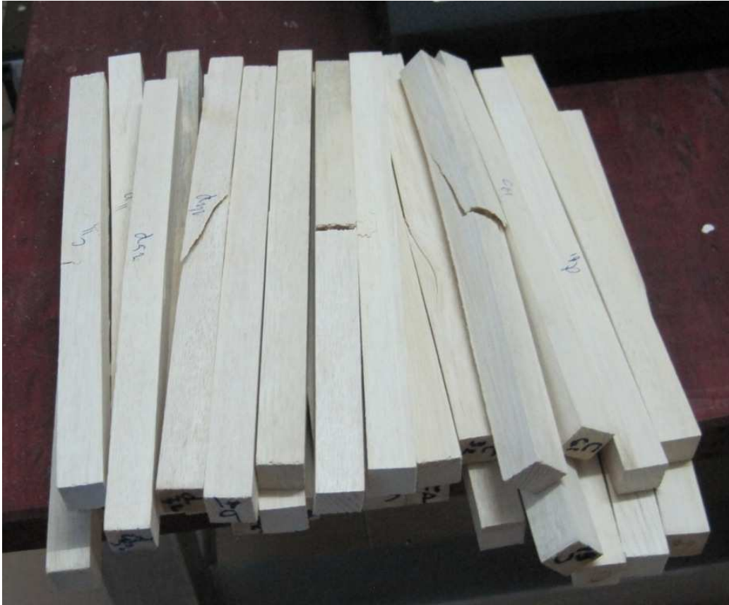
ຮູບທີ 15: ລັກສະນະການແຕກຫັກຕາມມາດຕະຖານຂອງ ASTM International (USA)
