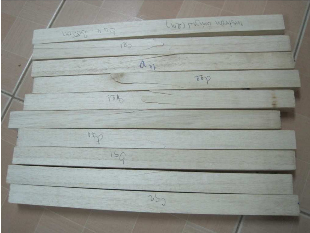
ຮູບທີ 16: ລັກສະນະຂອງການແຕກຫັກທີ່ບໍ່ມີໃນມາດຕະຖານ ASTM International (USA)
