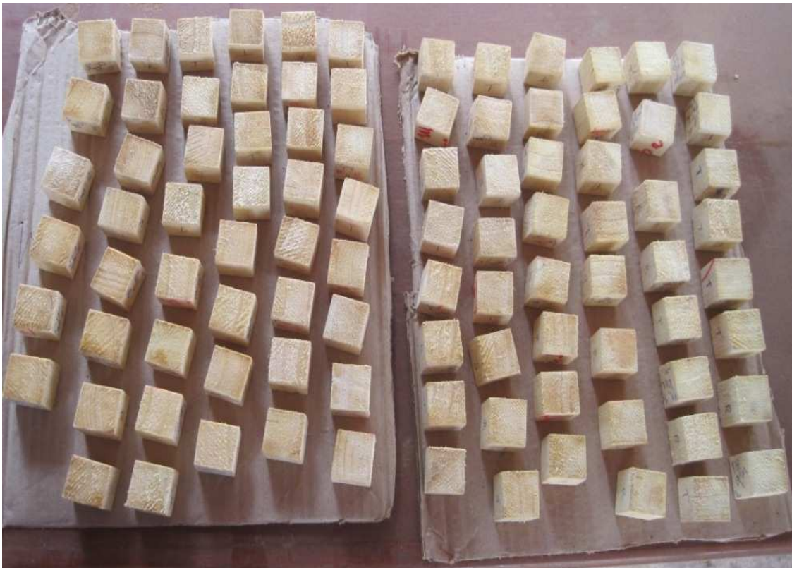
ຮູບທີ 6: ຂະໜາດ ແລະ ການຕາກອາກາດຂອງໄມ້ຕົວຢ່າງທີ່ນຳມາທົດສອບຄຸນສົມບັດກາຍະພາບ
