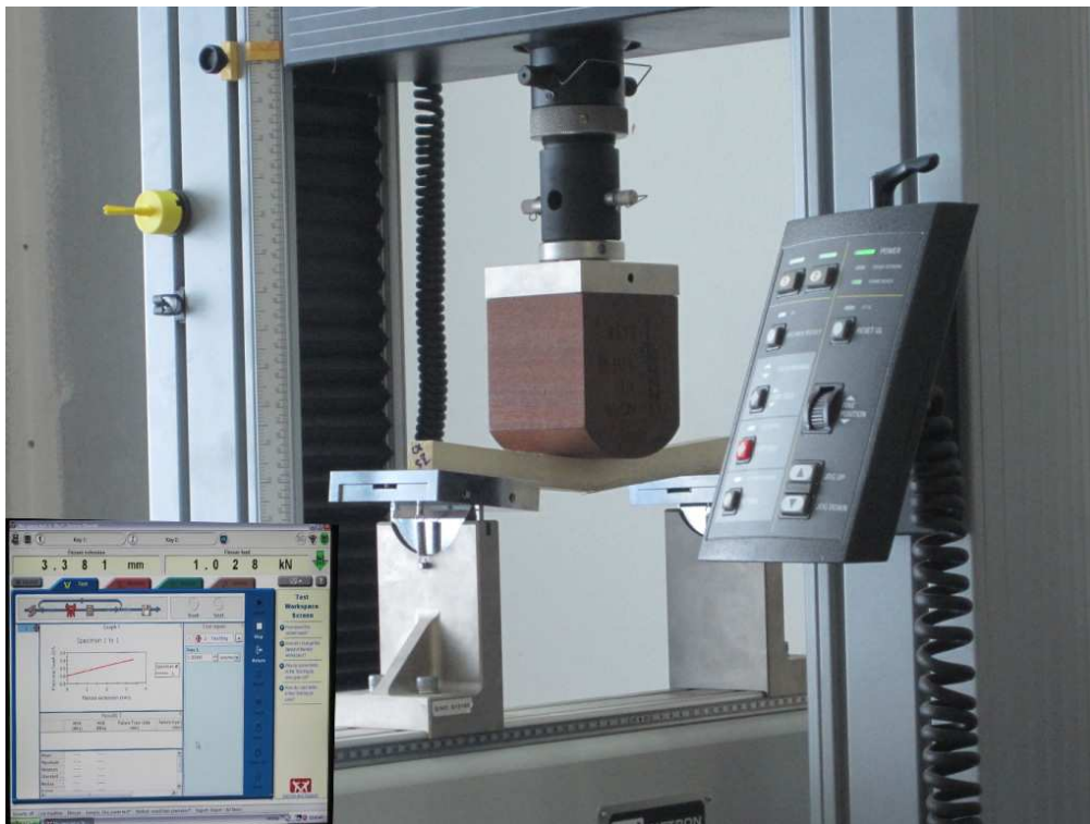
ຮູບທີ 10: ການທົດສອບຄຸນສົມບັດກົນລະສາດ ແລະ ການອ່ານຄ່າຂອງໂປຼແກຼມ Bleu hill
